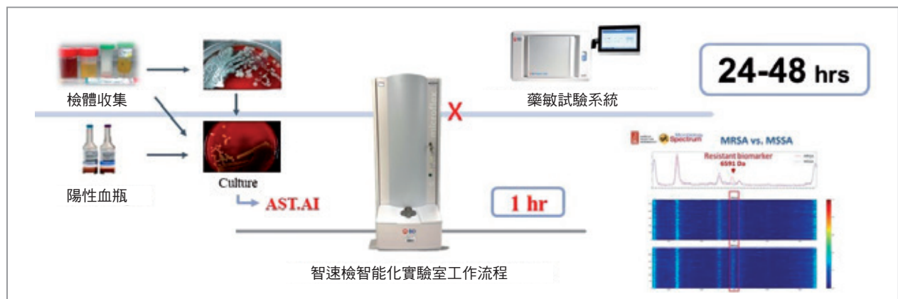
圖2：傳統培養方式要先將檢體接種至培養基上，待隔日菌落數夠才能純化並操作質譜儀獲得菌種名稱，之後再操作藥敏測試，曠日廢時。「智速檢抗藥性預測」直接使用培養基上菌落操作質譜分析，同時可以找出抗藥特徵，進而預測此菌株為抗藥性細菌，大大節省時間。
